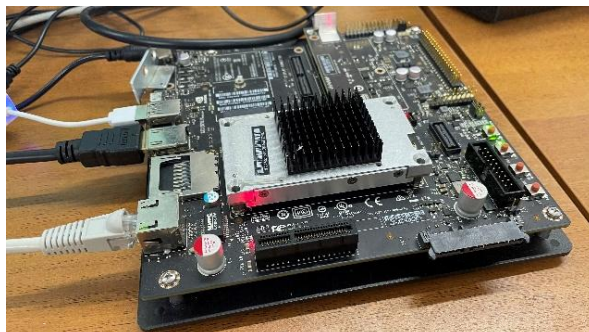
Рис. 3. Внешний вид модуля NVIDIA Jetson TX2, установленного на Mini-ITX
