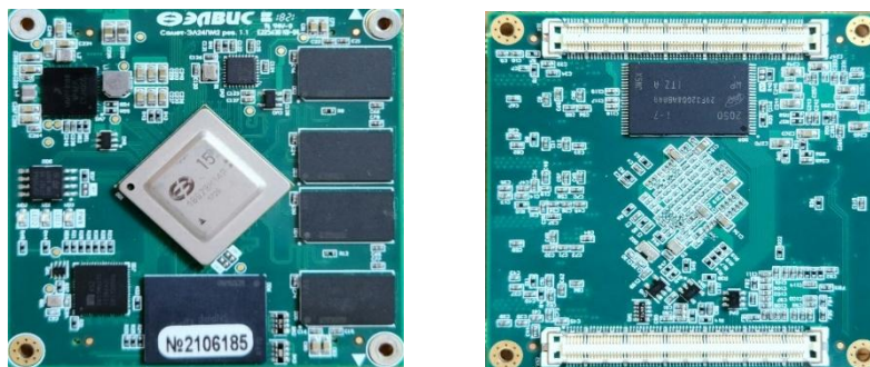
Рис. 8. Внешний вид модуля Салют- Л24ПМ2
